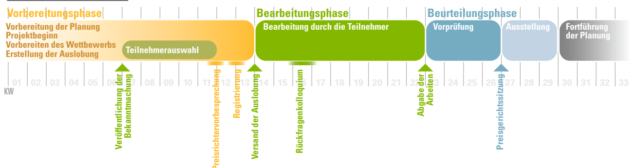
Abb. 8: Schema der Phasen, Schritte und Meilensteine eines einphasigen nichtoffenen Wettbewerbs, Grafik: C4C
